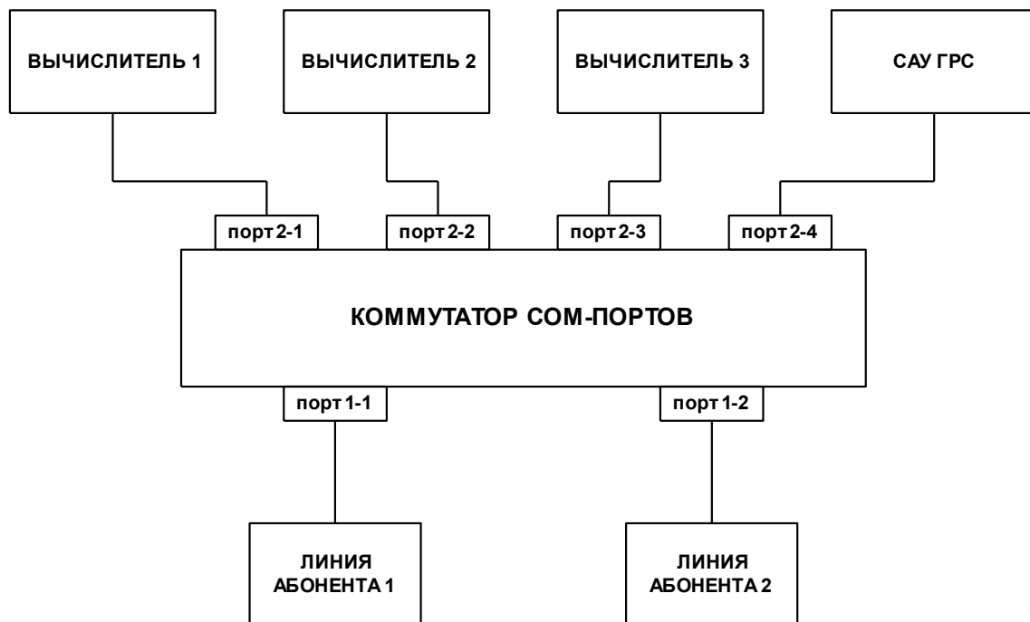
Рисунок 1 - Структурная схема коммутатора СОМ-портов.
